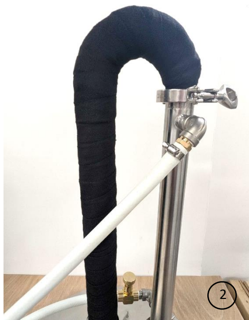
2 Installation du tuyau d'évacuation à la sortie du condenseur
