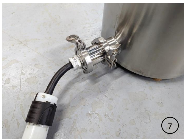
7 Élément électrique, régulateur et hublot installés sur un Pilot
