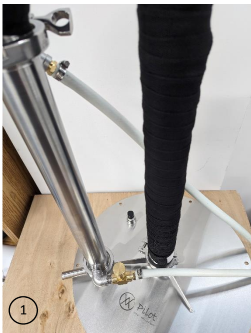
Installation du tuyau d'alimentation et de sortie de l'eau du condenseur
