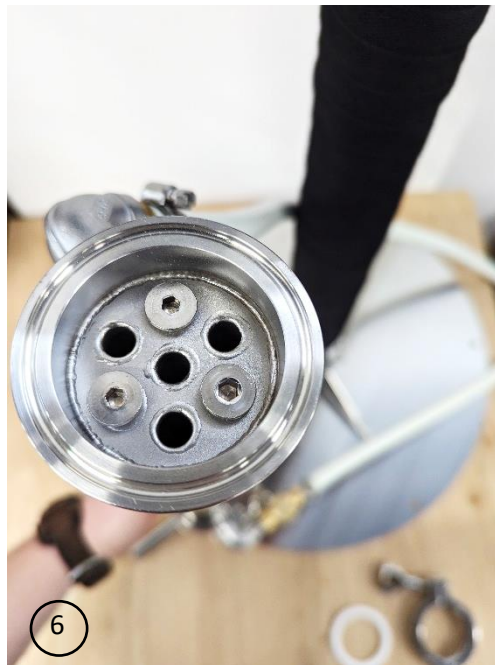
6 Restriction du condenseur avec deux vis à tête coniques
