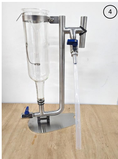
Installation de l'adaptateur et du tube en PTFE sur l'essencier (facilite le prélèvement de l'hydrolat)
