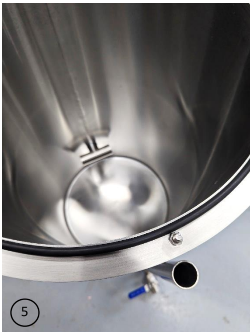
5 Installation du joint torique entre la bride et le couvercle
